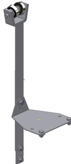
Laufkatze für INP 100 für Antriebsstation und Spannsektion
